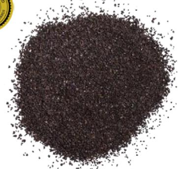
FERROLOX® es un granulado de hidróxido férrico (III) de estructura amorfa, hecho mediante un proceso patentado, además es regenerable.
